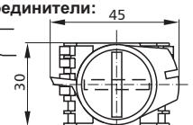
**N-427/P2p...Кнопка с поворотным двухпозиционным приводом самовозвращающимся из отклонения вправо**
